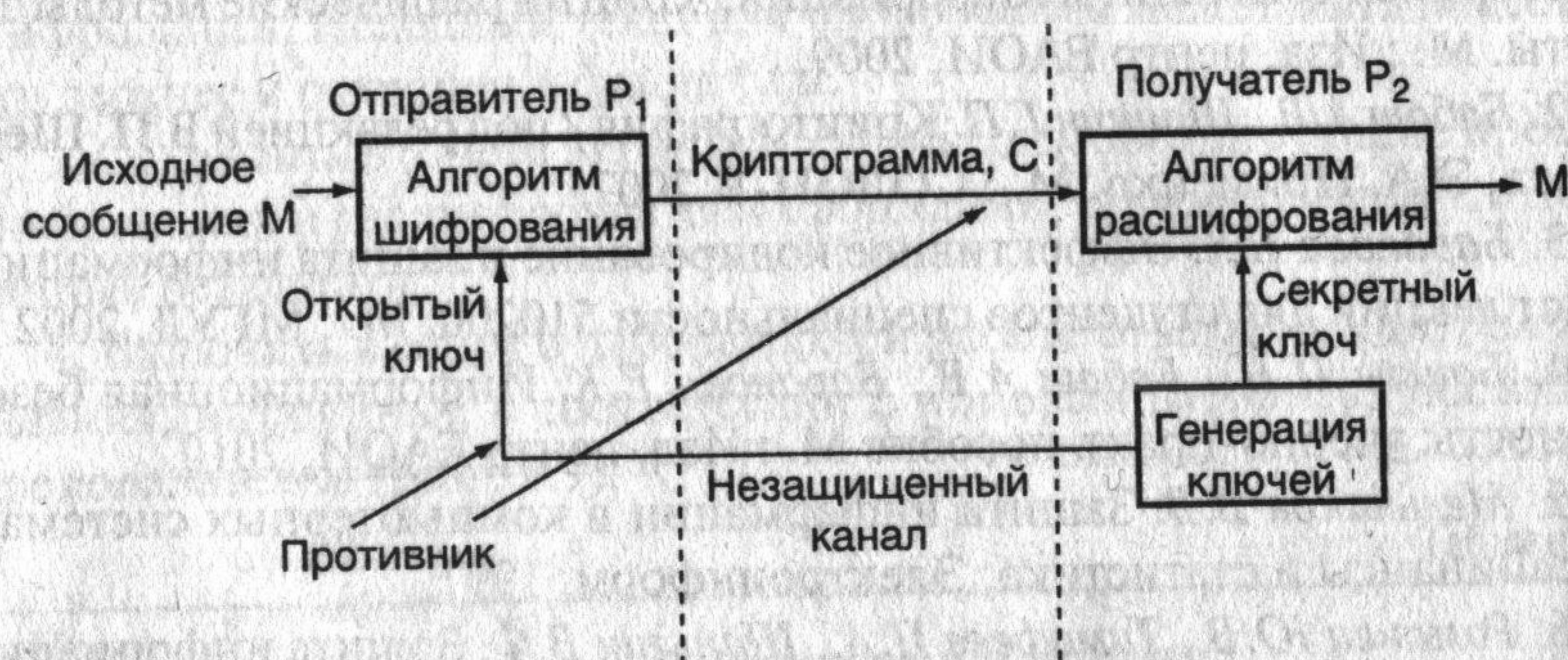
Рис. 2.1. Обобщенная схема асимметричной криптосистемы
