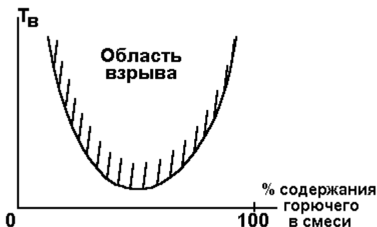
Рис. 4-6 Зависимость температуры самовоспламенения от состава смеси при постоянном давлении.
