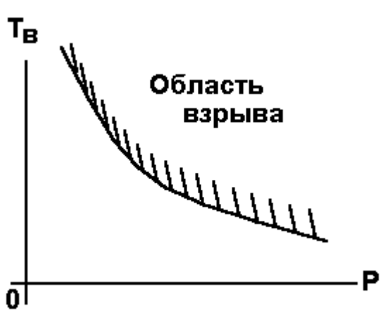
Рис. 4-5. Связь температуры воспламенения с давлением при постоянном составе смеси
